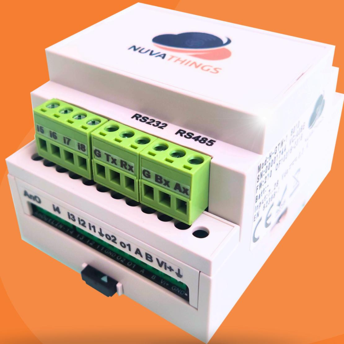
**Datalogger industrial multiprotocolo** para entornos exigentes y sistemas críticos. Compatible con sensores 4..20 mA, 0–10V, 0–3V y contadores de impulsos. Conectividad flexible:
